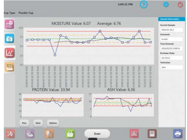
Affichage SPC (spectroscopique) configurable avec diagrammes de contrôle pour trois composants permettant un suivi précis du processus
